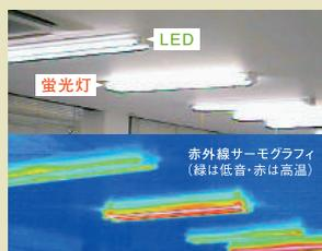
従来型蛍光灯の温度が約44℃なのに対してLEDタイプでは31℃程度。LEDタイプは室温の上昇抑制にも効果があることが分かります。
