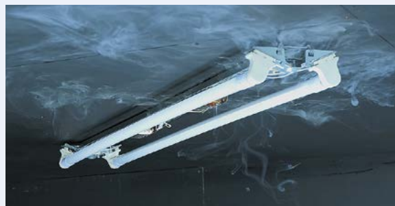
蛍光灯器具から発煙する様子 (カバーを外した状態での再現実験)
